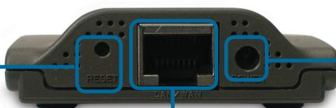
**Tombol Reset:** Digunakan untuk me-reset ke konfigurasi default.
