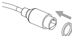
Протяните Ethernet-кабель через водонепроницаемый коннектор, как показано на рисунке.
