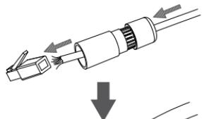
Coloque um conector RJ-45 na extremidade do cabo.
