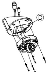
Remova a tampa e ajuste o ângulo e a rotação da câmera, conforme desejado, e volte a colocar a tampa. Parafuse a tampa da câmera novamente no lugar.
