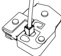
Branchez la prise RJ-45 dans le connecteur Ethernet, puis vissez le connecteur étanche dans le connecteur Ethernet en le tournant d'environ un demi-tour dans le sens horaire.
