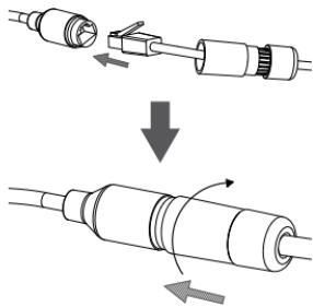
Conecte la clavija RJ-45 en el conector Ethernet y, a continuación, atornille el conector impermeable al conector Ethernet girándolo aproximadamente media vuelta hacia la derecha.
