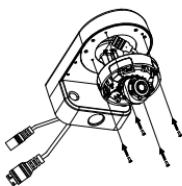
Coloque la cubierta de la cámara.
