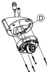
Ôtez le capot et ajustez l'angle et la rotation de la caméra comme souhaité, puis remettez le capot en place. Revissez le capot de la caméra.
