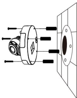
**При монтаже камеры на потолке** используйте отвертку для извлечения защитной пластиковой накладки в основании камеры, затем протяните кабели через отверстие.
