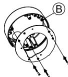
Retire la cubierta de la cámara.
