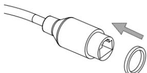
Enrosque el cable Ethernet desnudo a través del conector impermeable como se muestra.
