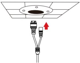
Connectez l'alimentation et les câbles Ethernet ou juste le câble Ethernet si vous utilisez une connexion PoE.
