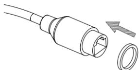
Far passare il cavo Ethernet attraverso il connettore impermeabile, come mostrato.
