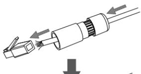
Klemmen Sie dann einen RJ-45-Stecker mit einer Crimpzange auf das Kabelende.
