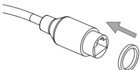
Führen Sie das blanke Ethernet-Kabel wie abgebildet durch den wassererdichten Stecker.
