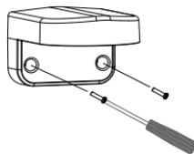
Arahkan konektor kamera melalui saluran kabel belakang atau bawah pada DCS-37-1. Kemudian sekrup pelat pemasangan ke braket dengan menggunakan set lubang pemasangan yang ditandai **B**.
