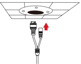
Conecte os cabos de energia e Ethernet, ou apenas o cabo Ethernet se você estiver usando uma conexão PoE.
