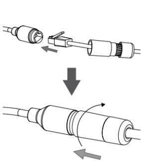
Sambungkan konektor RJ-45 ke konektor Ethernet, lalu pasang konektor kedap air ke konektor Ethernet dengan memutar searah jarum jam sekitar setengah putaran.
