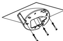
Retire la cubierta de la cámara.
