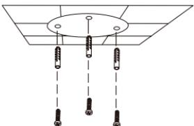
**Jika Anda meletakan kabel kamera di dalam dinding,** bor lubang di tengah dan tarik kabel melalui lubang.
