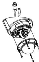
Pastikan penutup karet ada di sisi saluran kabel untuk menutupnya.
