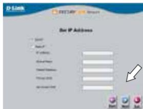
Pilih **IP Statis** jika Anda ingin secara manual memasukkan pengaturan IP untuk kamera.
