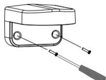
Протяните кабели с разъемами через нижний или боковой кабельный канал на DCS-37-1. Используя винты, закрепите монтажную плату к отверстиям, отмеченным знаком **B**, на DCS-37-1.
