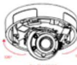
**Внимание:** диапазон перемещения объектива камеры ограничен; если она остановится во время выполнения регулировки, не пытайтесь поворачивать или наклонять камеру дальше в этом направлении.
