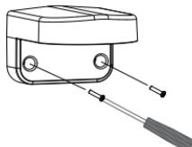
請將攝影機接頭穿過DCS-37-1背面或底部的線槽，再用包裝內附的螺絲對準標示為B的孔位來將壁掛背板鎖上。
