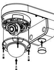
Jika Anda meletakan kabel kamera melalui dinding, letakkan penutup karet ke saluran kabel bawah untuk menutupinya.
