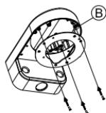
Retire la cubierta de la cámara.
