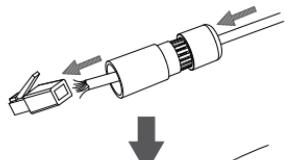
Fissare un connettore RJ-45 sull'estremità del cavo.
