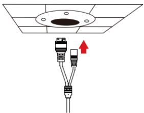
Sambungkan kabel daya dan kabel Ethernet, atau hanya kabel Ethernet jika Anda menggunakan koneksi PoE.
