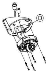
Entfernen Sie die Abdeckung und passen Sie Winkel und Drehung der Kamera nach Wunsch an, dann setzen Sie die Abdeckung wieder auf. Schrauben Sie die Kameraabdeckung wieder fest.
