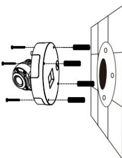
**Si vous montez la caméra au plafond**, utilisez un tournevis à tête plate pour enlever la protection de l'orifice en plastique du bas de la base, puis faites passer les câbles par le bas.
