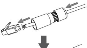
Memasang konektor RJ-45 di ujung kabel.
