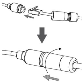
Aperte a parte traseira do conector impermeável no sentido horário até existir uma vedação apertada em torno do cabo Ethernet.
