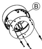
Снимите защитную крышку камеры.
