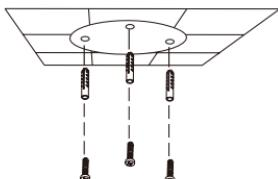
**Si vous faites passer les câbles de la caméra à travers le mur,** percez un trou au centre et tirez les câbles à travers le trou.
