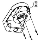
Entfernen Sie die Abdeckung der Kamera.
