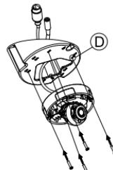
請將攝影機的防護罩取下，將傾角鎖定螺絲轉鬆來調整或轉動攝影機至您要的角度，再將防護罩鎖回攝影機。
