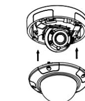
Vuelva a colocar la cubierta de la cámara.
