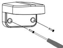
Guie os conectores da câmera através do canal de cabo traseiro ou inferior no DCS-37-1. Em seguida, enrosque a placa de montagem no suporte usando o conjunto de orifícios de montagem marcado **B**.
