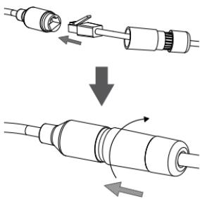
Drehen Sie den hinteren Teil des wasserdichten Steckanschlusses im Uhrzeigersinn, bis eine feste Abdichtung um das Ethernet-Kabel erreicht ist.
