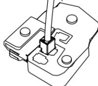
Conekte o plugue RJ-45 no cabo de Ethernet e, em seguida, parafuse o conector impermeável ao conector Ethernet girando-o no sentido horário por cerca de meio turno.
