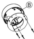
Entfernen Sie die Abdeckung der Kamera.
