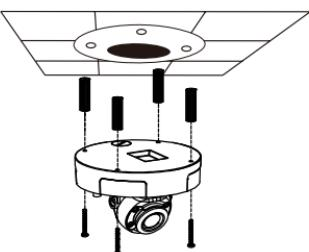
Utilisez les vis fournies pour monter la caméra au plafond.
