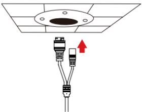
Подключите кабели питания и Ethernet. При использовании технологии PoE подключите только Ethernet-кабель.
