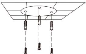
**Se i cavi della videocamera sono nascosti nel muro,** praticare con il trapano un foro al centro e far passare i cavi attraverso il foro.
