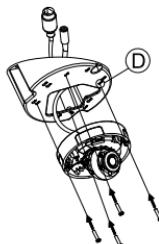
Retire la cubierta y ajuste el ángulo y la rotación de la cámara como deseé; a continuación, vuelva a colocar la cubierta en su lugar. Atornille de nuevo la cubierta de la cámara en su sitio.
