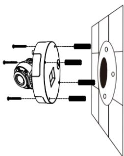
**Si está montando la cámara al techo, use un destornillador plano para retirar la cubierta de plástico del orificio de la parte inferior de la base y pase los cables por la parte inferior.**
