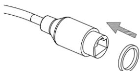
Coloque o cabo Ethernet através do conector impermeável, como mostrado.
