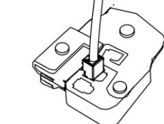
Stecken Sie den RJ-45 Stecker in den Ethernet-Steckverbinder und drehen Sie den wassererdichten Steckanschluss im Uhrzeigersinn etwa eine halbe Umdrehung auf den Ethernet-Steckverbinder.
