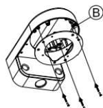
Снимите защитную крышку камеры.
