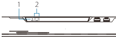
Figure 1 : Voyants lumineux en façade
