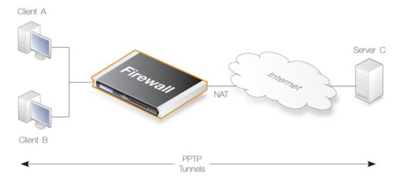
Figure 6.6. PPTP ALG Usage
