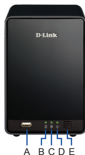
Рис. 1. Передняя панель DNR-326
