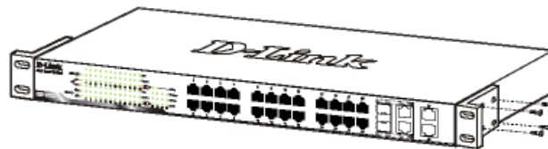
圖 2. 固定機架固定架
