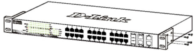
Figura 2. Fijar los ángulos de montaje
