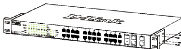
Figura 2. Fissaggio delle staffe di montaggio
